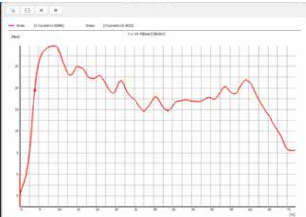
*Stress-Strain curve obtained from Photron high speed camera and piezoelectric load cell. / Curva sforzo-deformazione ottenuta dalla telecamera ad alta velocità Photron e dalla cella di carico piezoelettrica.*
